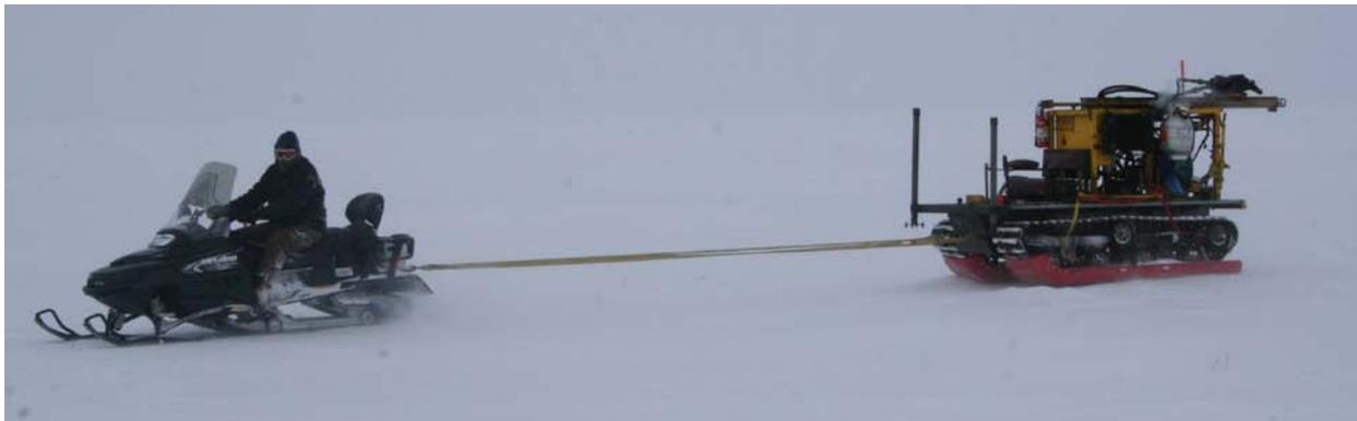
FIGURE 12 - DOT&PF'S B24 DRILL TRANSPORTED BY SNOWMACHINE
